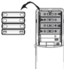
**2. Installare il modulo per il radiocomando**
