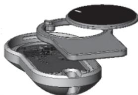
c. Sortir la carte électronique avec la pile et retirer la pile.
