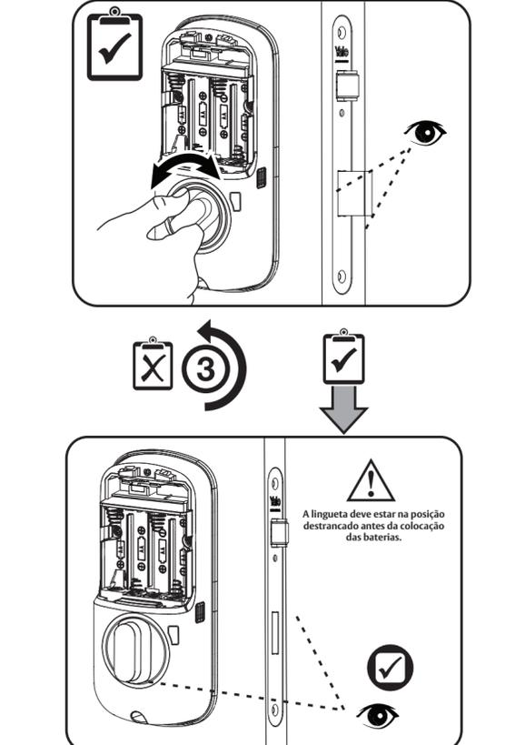
**8** Instalação da tampa do compartimento das baterias/Ajuste do lado de abertura da porta
