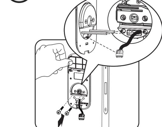
**2** Instalação da Fechadura Digital YRD256 RL;
