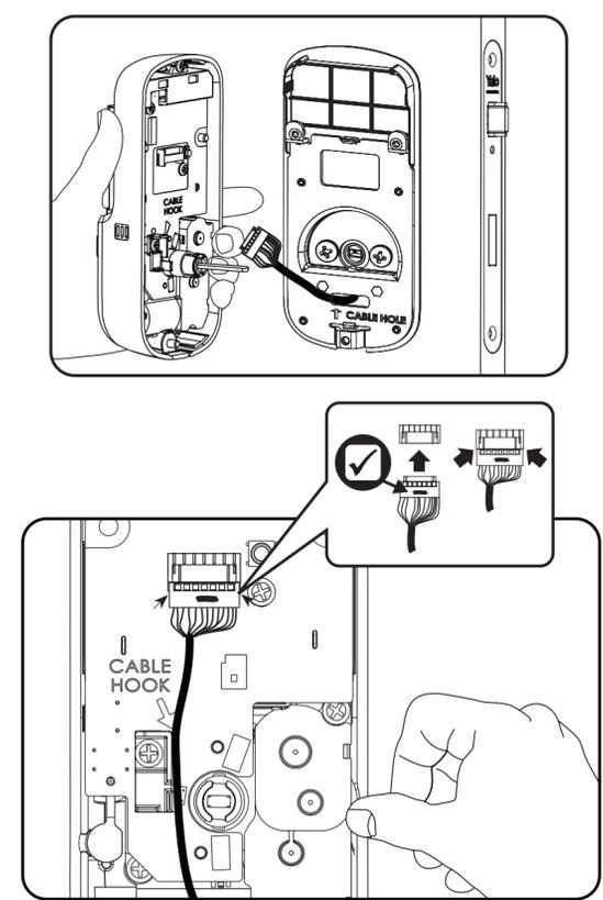
**6** Verifique a posição da tranqueta e faça a montagem do lado interno da fechadura digital com a fechadura ST2-55 RL;
