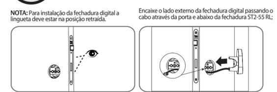
**5** Conecte o cabo no lado interno da fechadura digital (verifique posição);
